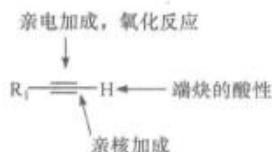
图3-9 炔烃发生反应时化学键断裂位置
